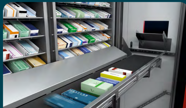
Após o pedido, os medicamentos deslizam para a correia transportadora de recolha bidireccional - Ultra-Multipick-sistema de entrega
