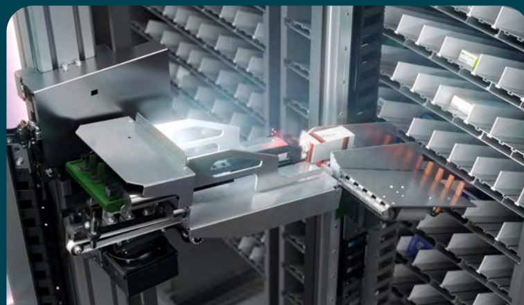
Transferência dos medicamentos da pinça do sistema para o portal de armazenamento totalmente automático do RAPID
