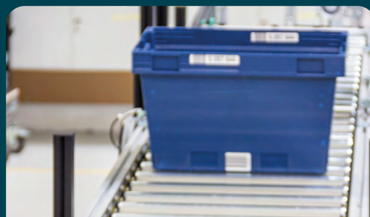
A recolha de encomendas específicas pode ser efectuada em caixas de recolha com sistema de transporte de rolos ligado
