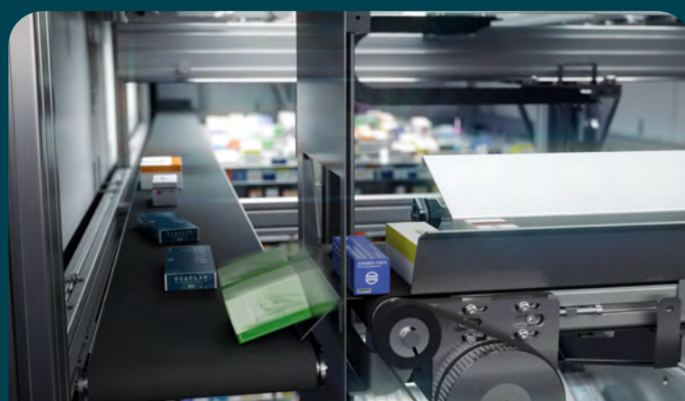
Os medicamentos são transportados para o sistema de transporte ligado ou directamente para o dispensador através do transportador de recolha bidireccional, regulável em altura.
